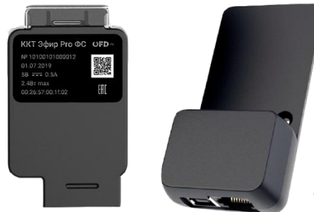
Регистратор Эфир Pro ФС с коннектором "X1" для подключения к сети Ethernet и блоку питания
